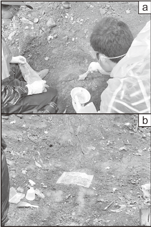
図4 a. K/Pg境界の露頭表面に合成樹脂を塗布している様子。 b. 裏打ち材として不織布を貼り付けた様子。
