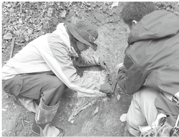
図6 ハンマーやボールを用いて、慎重に剥ぎ取る様子。
