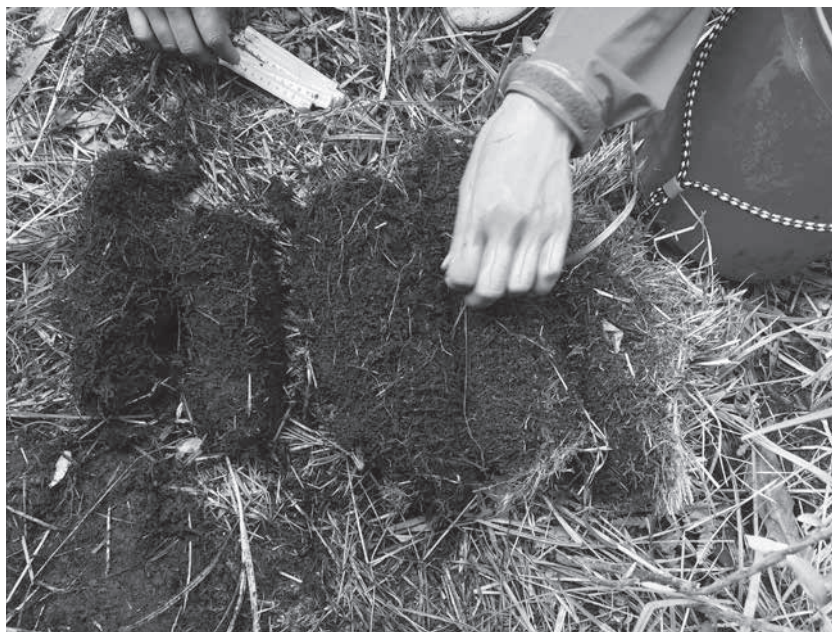
図4 天頂部（右）から地際（左）へ5cm ごとに縦断面を分割し、横断面と共に比較
