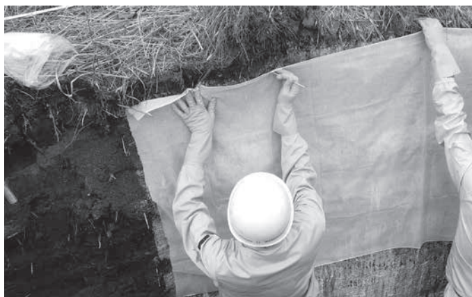
写真5 裏打ち（布の貼り付け）
