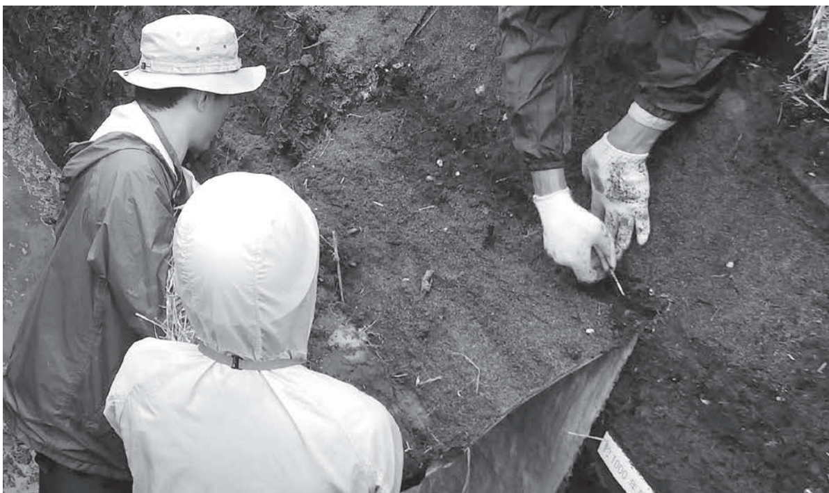
写真8 地層の欠落部分が出ないように根切りハサミを用いながら慎重に剥ぎ取る
