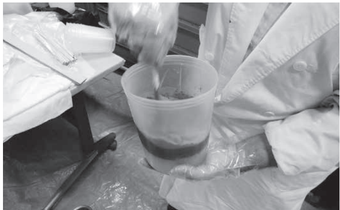
写真13 接着剤の調合（マイクロバルーンを添加した状態）
