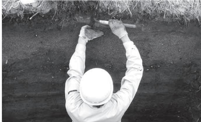
写真2 ねじり鎌を用いた壁面の整形
