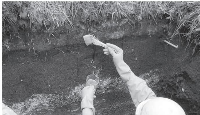
写真4 2回目の合成樹脂の塗布(刷毛を使用)
