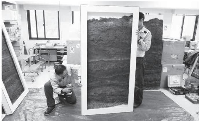
写真14 フレームの取り付け作業
